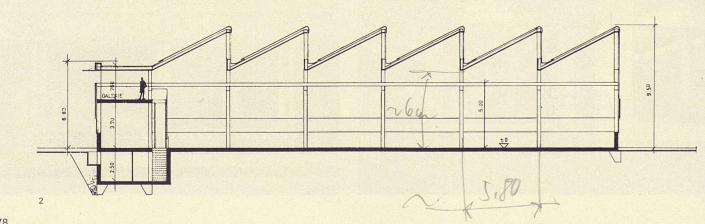
Die Halle zeigt im Längsschnitt ein Sheddach; sie besteht aus einem Stahlskelett mit Durisol-Großtafelverkleidung und ist seitlich erweiterbar
