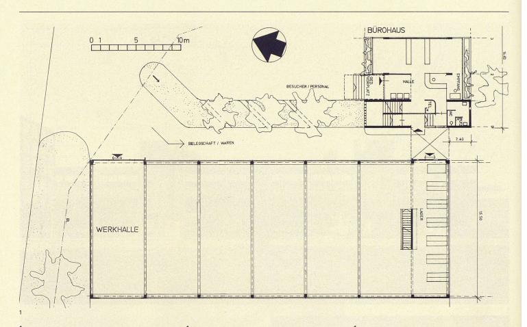
Grundriß der Werkhalle für die Herstellung von Präzisionswerkzeugen in Nänikon mit Bürogebäude, Erdgeschoß Plan de l'atelier de fabrication de l'usine d'outils de précision de Nänikon, avec bâtiment administratif, rez-de-chaussée
