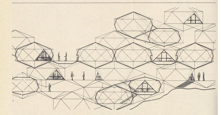
Vertikalschnitt durch die Raumstadtstruktur. Die einzelnen Raumzellen können auf zwei verschiedene Arten aufeinandergestellt werden: entweder Fläche auf Fläche oder mit einem der beiden Zusatzstücke Kante auf Kante
