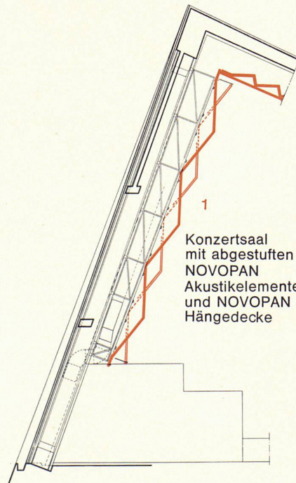
Konzertsaal Schrägwand, Vertikalschnitt Elemente aus NOVOPAN 40 mm, furniert und NOVOPAN Hängedekce
