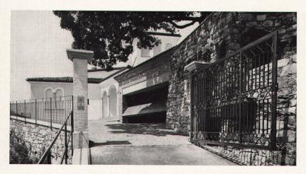
Einflügliges (oder zweiflügliges Parkabschlußtor sowie Kipptor werden unabhängig voneinander mit Funk oder Schlüssel von außen und Funk oder Druckknopf von innen geöffnet und geschlossen.
