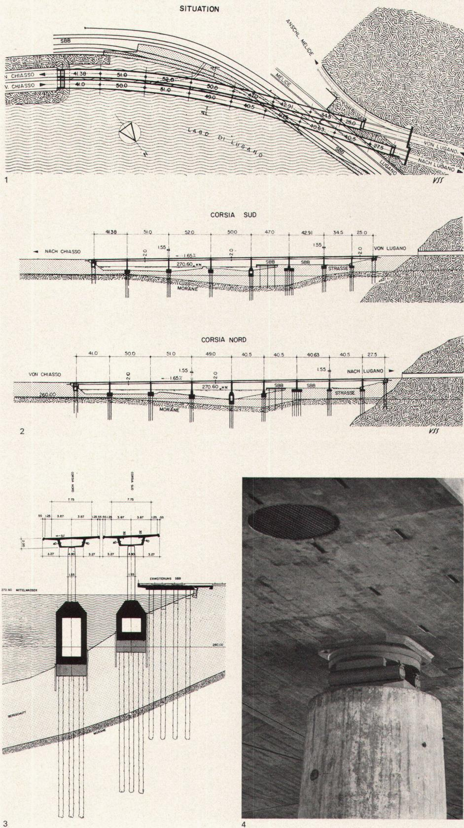
platte versehen, deren Zweck ein doppelter ist: Einerseits entfallen damit Schutzdächer zwischen den Kastenträgern, andererseits kann ein Fahrbahnwechsel des Verkehrs von Fahrbahn A zu B mühelos auf der Brücke erfolgen, wenn aus irgendwelchen Gründen eine Tunnelröhre gesperrt werden müßte.
