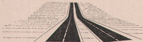
SCHLECHTES BEISPIEL: ÜBERGANG VON 2% ABFAHRT ZU EINER 3% AUFFAHRT. MINIMALKURVE FÜR 110 KM/h. KURVENLÄNGE: CA 230 M RADIUS CA 4'500 M
