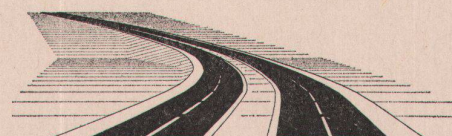
Gutes Beispiel: Langer Sattel in langer Horizontalkurve
