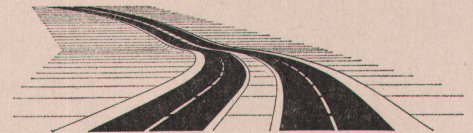
Schlechtes Beispiel: kurzer Sattel in langer Horizontalkurve
