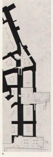
Schnitt durch die erste unterirdische Ebene im Bereich der Bahnhofstraße. Der Plan zeigt die vorgeschlagenen zweigeschossigen unterirdischen Ebenen für den Fahr- und Fußgängerverkehr unterhalb der Pestalozzianlage und des Bereiches Bahnhofstraße/Uraniastraße/Sihlstraße
