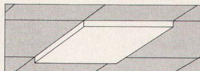
Apropos Abdeckung: Sie ist aus opalisiertem Acrylglas von durchgehend gleicher Dicke und Festigkeit, nach unserem eigenen Verfahren scharfkantig gebogen (ein Verfahren notabene, das uns erlaubt, unabhängig von fixen Massen Abdeckungen in genau der Form und Grösse zu bauen, wie sie für den einzelnen — für Ihren Fall erforderlich sind).
