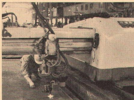
ziert» wird. Im Hinblick auf die Wirtschaftlichkeit der Herstellung wurden elektronisch gesteuerte Schneidevorrichtungen entwickelt.
