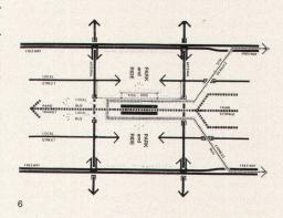
Die Verbindung der Autobahnen mit anderen Verkehrsträgern und mit Parkplätzen muß gewährleistet sein in Form eigentlicher Umsteigebahnhöfe eigenen Trasse, getrennt von allen anderen Verkehrswegen. In den Stadtzentren konnte dies nur unterirdisch erreicht werden. Die neue Schnellbahnwelle hat ihren Ursprung in der Akzelleration des Autoverkehrs und der Unfähigkeit, durch Straßenbaumaßnahmen die Verkehrsverstopfungen zu beheben.
