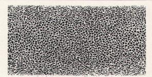
Geschlossene Zellstruktur. In einem speziellen Extrusionsverfahren entsteht ein Hartschaum mit vollkommen geschlossenen Zellen und einer hochverdichteten Oberfläche.
