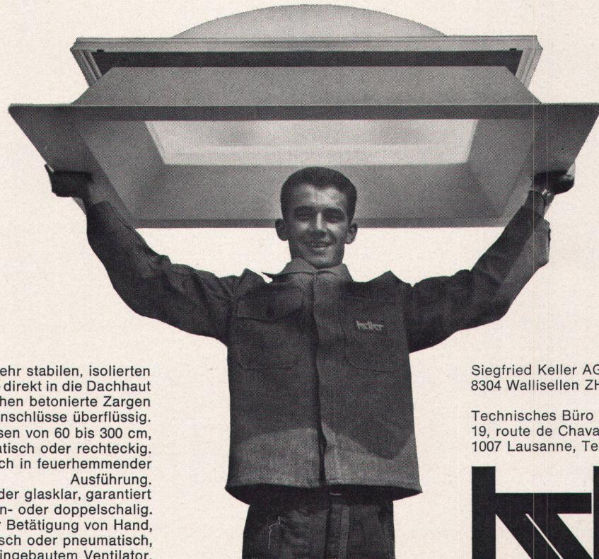
Die leichten, aber sehr stabilen, isolierten Aufsatzkränze, die direkt in die Dachhaut geklebt werden, machen betonierte Zargen und Blechanschlüsse überflüssig. 30 verschiedene Größen von 60 bis 300 cm, rund, quadratisch oder rechteckig. Alle Typen auch in feuerhemmender
