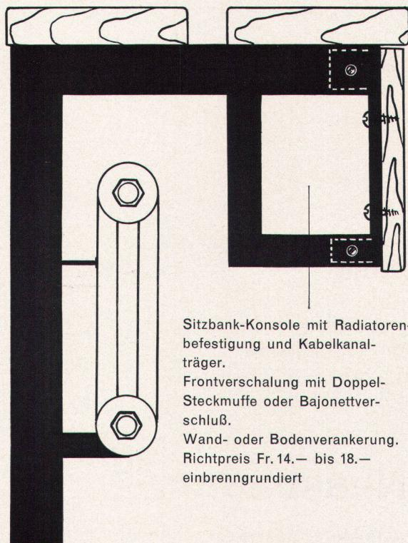
Sitzbank-Konsole mit Radiatorenbefestigung und Kabelkanalträger.
