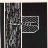
Die harte Deckschicht zusammen mit den groben Mittellagespreißeln ergeben die große Festigkeit. Deshalb die vorzügliche Schraub- und Nagelfestigkeit jeder NOVOPAN-Platte!
