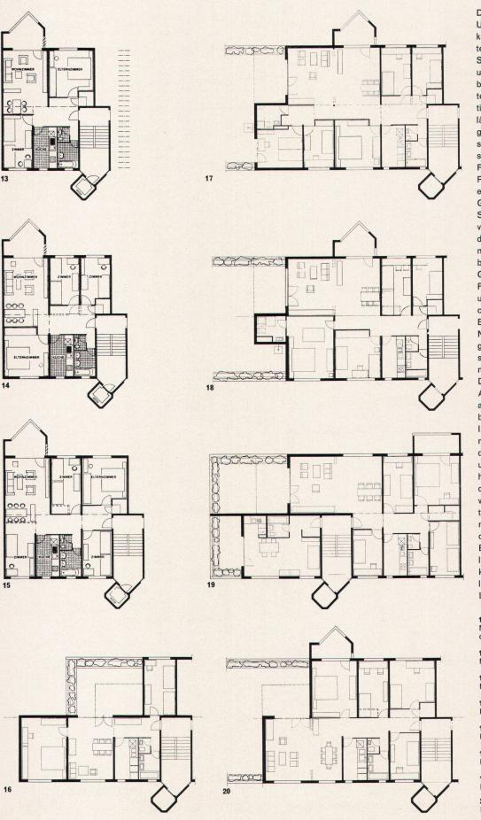
Durch die Eliminierung der Gipser- und Unterlagsbodenarbeiten sowie durch die konsequente Verwendung standardisierter vorgefertigter Ausbauelemente wie Sanitärblocks, Fenster, Türen, Böden usw. sowie durch die bei der Fabrikation bereits in die Elemente eingelegten Bauteile wie Türzargen, elektrische Installationen und diverse Befestigungsteile läßt sich der kostenanteilmäßig überwiegende Innenausbau nach ähnlichen Gesichtspunkten wie der Rohbau rationalisieren.
