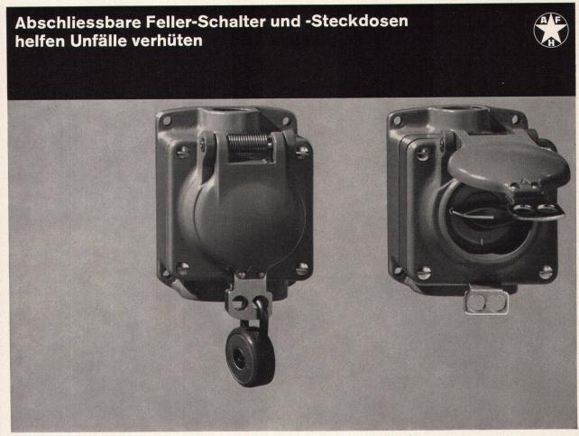
Schalt- und Steckvorrichtungen von zugänglichen Flammräumen oder Kaminen müssen aus sicherheitstechnischen Gründen abschliessbar sein. Für diese und ähnliche Fälle eignen sich die abschliessbaren Feller-Schalter und -Steckdosen in Gussausführung.
