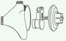
1 fester Körper + 1 auswechselbares Steuerelement + 1 Einstellgriff = 3 Teile, das ist alles!
