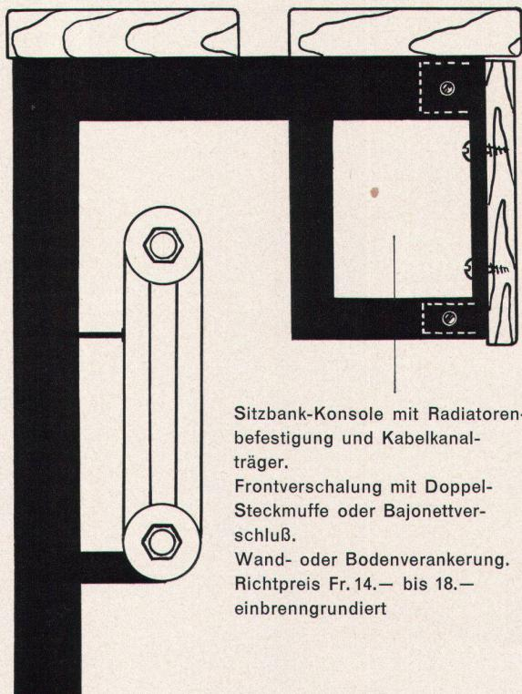
Sitzbank-Konsole mit Radiatorenbefestigung und Kabelkanalträger.
