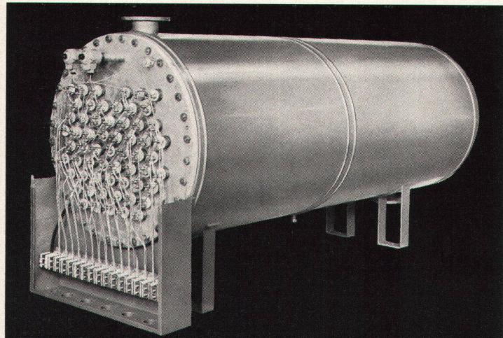
**Elektrische Durchflußheizer mit ausziehbarem Heizregister für Schwimmbäder und andere Zwecke, Leistungen bis 600 kW, Betriebsdruck bis 6 kp/cm<sup>2</sup>**
