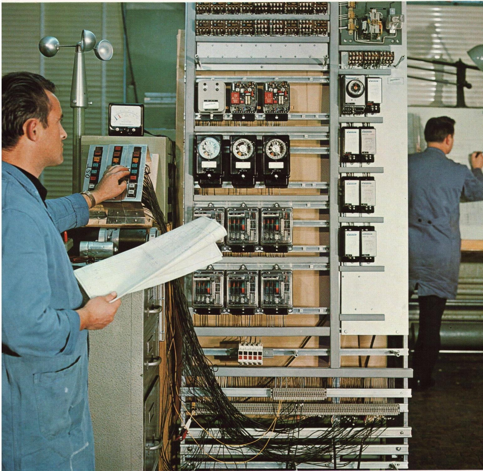
Zum Bild: Fertigstellung einer Schaltanlage zur vollautomatischen Bedienung aller Storen an einem Hochhaus in Deutschland
