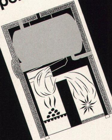
Dank zwei getrennten Brennkammern ist jederzeit, ohne Umstellung am Kessel, ein Verfeuern von Öl und festen Brennstoffen möglich.
