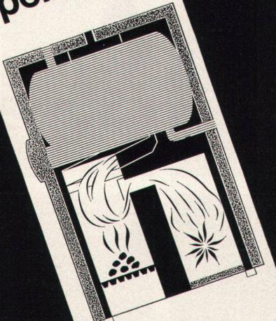
Dank zwei getrennten Brennkammern ist jederzeit, ohne Umstellung am Kessel, ein Verfeuern von Öl und festen Brennstoffen möglich.
