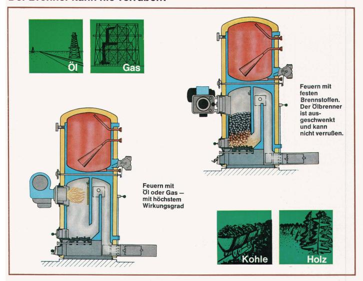
Die runde, starke Konstruktion erlaubt einen Betriebsdruck von 3 atü. Ein sehr wichtiger Punkt, da die meisten modernen Heizungen als Druckanlagen gebaut werden. Schwache und leichte Kessel werden nach Jahren Schäden zeigen.
