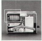
Kernstück des Braun permanent ist ein Magnetsystem. Beim Herunterdrücken der Taste wird mechanische Energie in einen elektrischen Funken umgewandelt.
