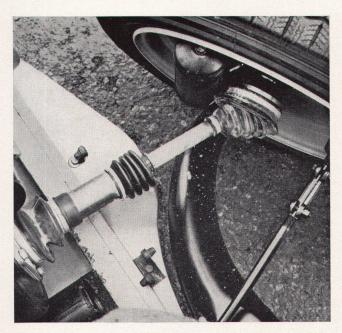
Vorderradaufhängung des 2 CV mit Trägheitsdämpfer
