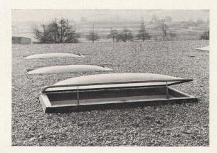
Hinten: Form A zum direkten Einbau in die Dachhaut Vorne: Form B zum Einbau auf Aufsatzkranz mit oder ohne Lüftung
