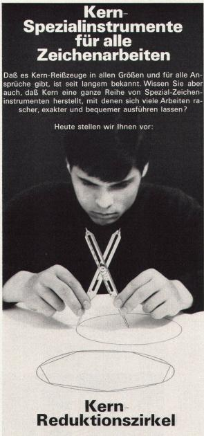
Diese überaus praktischen Präzisionsinstrumente sind sehr vielseitig verwendbar. Einige Beispiele: Übertragen von Strecken in beliebigen Maßstäben. Teilen von Strecken und Kreisumfängen in eine beliebige Anzahl gleiche Abschnitte. Teilen von Strecken in einem bestimmten Verhältnis (z. B. im Goldenen Schnitt).
