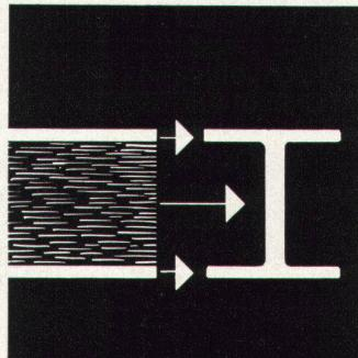
Die Funktion des dreischichtigen Aufbaus jeder NOVOPAN-Platte entspricht derjenigen eines statisch berechneten Trägers.
