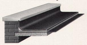
Eine weitere Möglichkeit Mit Wärmedämmung und Dampfsperre
