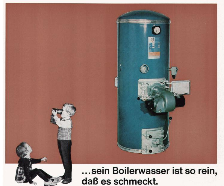
Denn sein Boilerinneres ist aus echtem Kupfer. Kupfer ist rein und dauerhaft. Der Mantel ist aus Stahl – zähem Schwedenstahl. Stahl ist stark. Zwischen Kupfer und Stahl liegt ein Kontaktmittel als Schnellwärmeleiter. Dieses Konstruktionssystem ist so ausgezeichnet, daß man es patentiert hat. Sie finden es nur bei Arvika.
