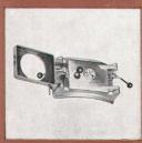
Die rechte Klappe verschließt den Feuerungsraum bei Abbrand fester Brennstoffe. Die linke bleibt währenddessen ausgeschwenkt.
