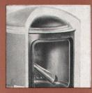
Dieser Teilquerschnitt beweist die hervorragende Isolierung des Arvika Kessels. Sie kommt – wie viele andere Eigenarten – der Wirtschaftlichkeit zugute. Isolierungsschutzdicke 50 mm. Material: Steinwollmatte.
