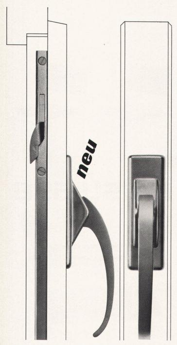
Verdeckter Riegelverschluss mit starken Anzugshaken, für 1-fl. Fenster und Türen in Einfach-, Doppel- und Isolierverglasung. Vespa-Griff mit schraubenloser Deckplatte. Weitgehend maschinelle Montage.
