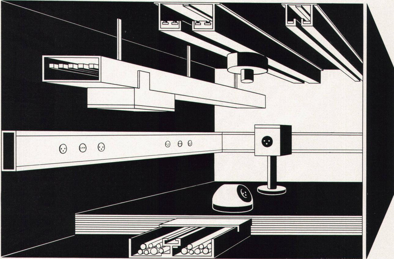
Stromkanäle bis 400 A, 500 V
