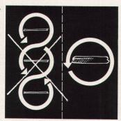
Die Mittellage des dreischichtigen Aufbaus besteht aus groben Spreißeln, wodurch sich eine kleine zu beleimende Fläche ergibt. Deshalb die einwandfreie, dauerhafte Verleimung
