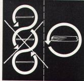
Die Mittellage des dreischichtigen Aufbaus besteht aus groben Spreißeln, wodurch sich eine kleine zu beleimende Fläche ergibt. Deshalb die einwandfreie, dauerhafte Verleimung
