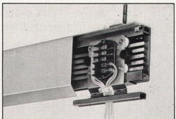
Schleifkontaktleitungen bis 80 A/500 V mit fahrbarem Stromabnehmer, 4-16 polig, für Kranbahnen, Laufkatzen, bewegliche Elektrowerkzeuge etc.
