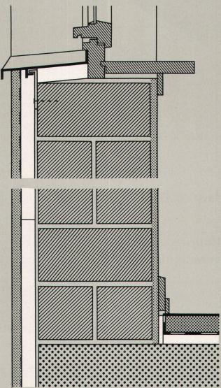
Einschalige Außenwände aus Isoliersteinen, 24 cm dick, erreichen oft nicht den erwünschten Wärmeschutz. Durch das Anbringen einer zusätzlichen Isolierung mit Hartschaumplatten aus STYROPOR kann man allen Anforderungen auch in ungünstigen Lagen – z. B. bei freistehenden Gebäuden – gerecht werden.
