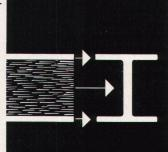
Die Funktion des dreischichtigen Aufbaus jeder NOVOPAN-Platte entspricht derjenigen eines statisch berechneten Trägers.
