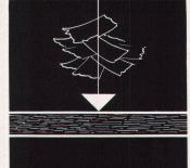
Spezielle, kreuz und quer verleimte Feinspäne ergeben eine millimeterdicke, richtungslose, tadellos plane und dichte Absperrung. Deshalb die schöne und ruhige Oberfläche jeder NOVOPAN-Platte!
