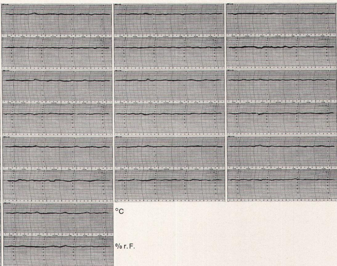
zum Beispiel in einem Raum ganzjährig die Toleranzen der Temperatur innerhalb von  $\pm 1^{\circ}\text{C}$  und diejenigen der Feuchtigkeit bei  $\pm 3\%$  r.F. halten (und dies mit einer Standardanlage).
