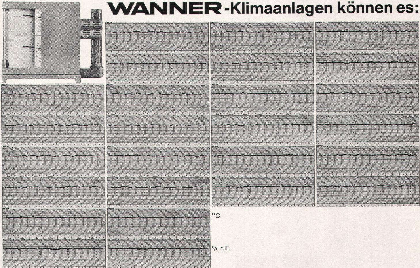
zum Beispiel in einem Raum ganzjährig die Toleranzen der Temperatur innerhalb von  $\pm 1^{\circ}\text{C}$  und diejenigen der Feuchtigkeit bei  $\pm 3\%$  r.F. halten (und dies mit einer Standardanlage).
