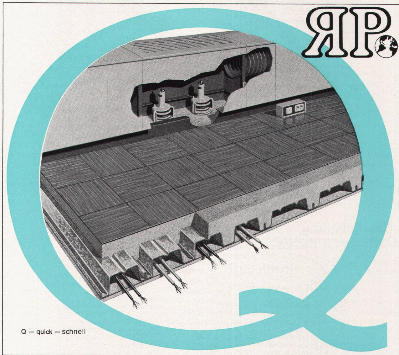
**... weil die Decke eingebaute Kanäle zur Luftverteilung hat!**
