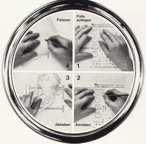
Verblüffend einfacher Vorgang. Saubere Darstellung der meistverwendeten sanitären Apparate im Masstab 1:20, 1:50 oder 1:100. Darstellungsart auf Plattenraster 15,3 cm ausgerichtet.
