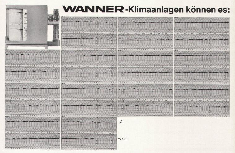
zum Beispiel in einem Raum ganzjährig die Toleranzen der Temperatur innerhalb von  $\pm$  1 °C und diejenigen der Feuchtigkeit bei  $\pm$  3% r.F. halten (und dies mit einer Standardanlage).
