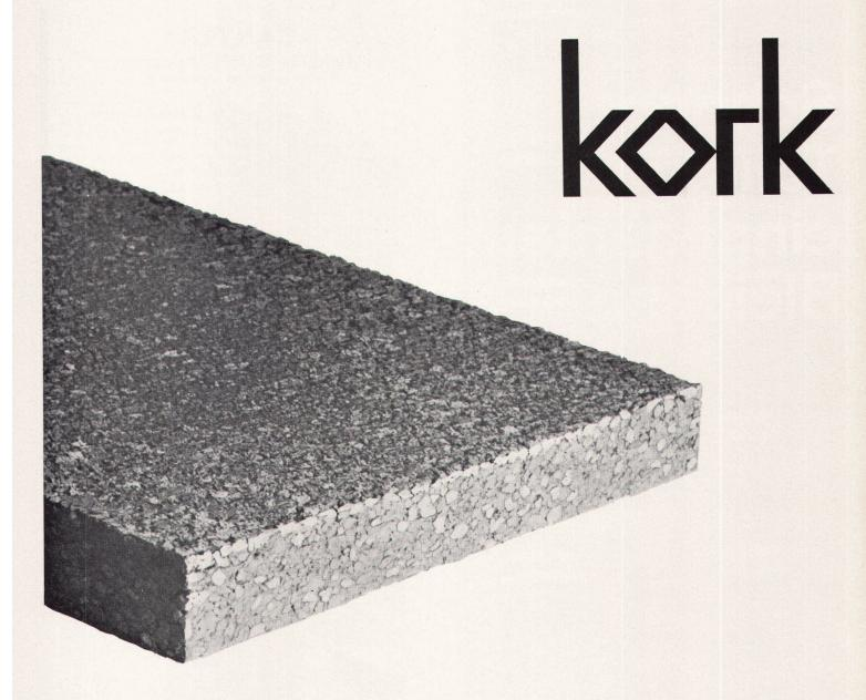
Kork ist ein hochwertiges Isoliermaterial gegen Kälte und Wärme. Seine Wärmeleitzahl beträgt nur 0,028 Kcal/m, h, °C (Bestwert bei Zimmertemperatur\*). Kork altert nicht, schwindet nicht und wird geschätzt wegen seines Verhaltens gegenüber Feuchtigkeit; seine luftgefüllten Zellen sind wasserabstossend und können atmen. Jedes hochwertige Isoliermaterial muss elastisch sein; Kork ist sogar dauerelastisch.
