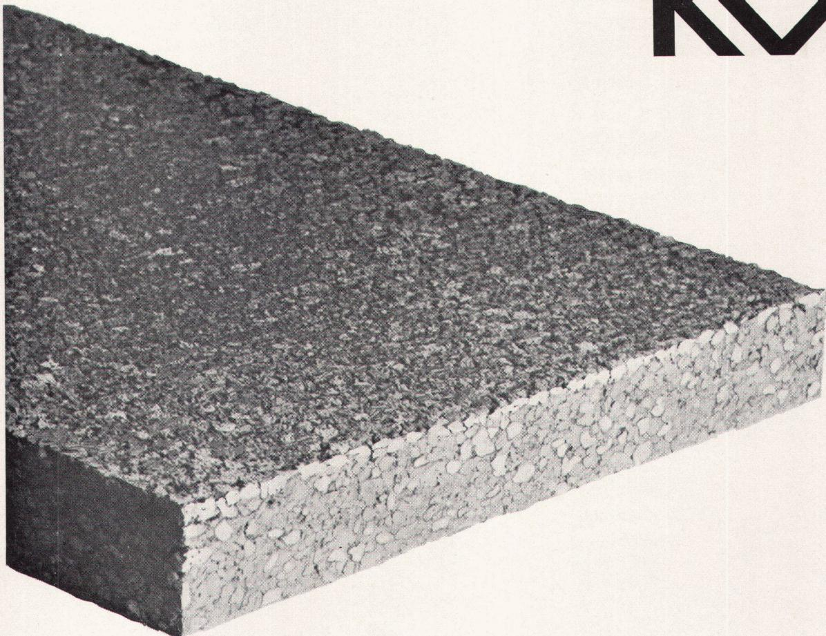
Kork ist ein hochwertiges Isoliermaterial gegen Kälte und Wärme. Seine Wärmeleitzahl beträgt nur 0,028 Kcal/m, h, °C (Bestwert bei Zimmertemperatur\*). Kork altert nicht, schwundet nicht und wird geschätzt wegen seines Verhaltens gegenüber Feuchtigkeit; seine luftgefüllten Zellen sind wasserabstossend und können atmen. Jedes hochwertige Isoliermaterial muss elastisch sein; Kork ist sogar dauerelastisch.
