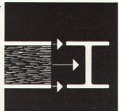
Die Funktion des dreischichtigen Aufbaus jeder NOVOPAN-Platte entspricht derjenigen eines statisch berechneten Trägers.
