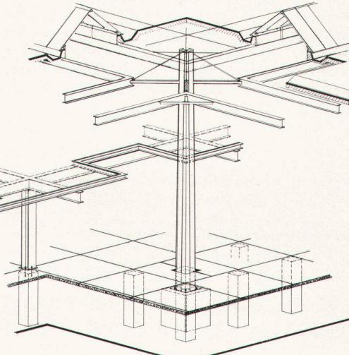
paneelen, bekleidet mit Wellasbestzement. Das Innere ist teilweise zweigeschossig; die sekundäre Tragstruktur der Einbauten ist ebenfalls in Stahl ausgeführt; die Böden und die Trennwände sind vorfabrizierte Betonplatten und Sandwichpaneelle.
