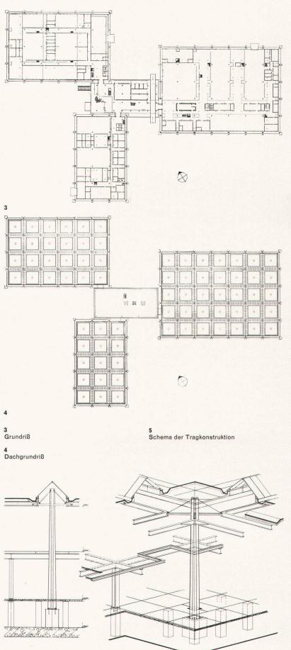
paneelen, bekleidet mit Wellasbestzement. Das Innere ist teilweise zweigeschossig; die sekundäre Tragstruktur der Einbauten ist ebenfalls in Stahl ausgeführt; die Böden und die Trennungswände sind vorfabrizierte Betonplatten und Sandwichpaneele.
