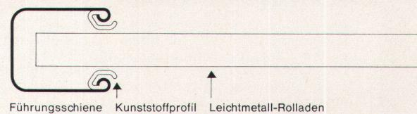
Führungsschiene   Kunststoffprofil   Leichtmetall-Rolladen
