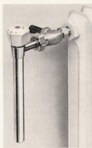
Das Kuglotherm-Ventil ist ein einfaches Organ ohne elektrischen Teil. Es besteht aus dem thermostatischen Wärmefühler und dem Ventilkörper. Der wärmeempfindliche Thermostat wirkt regulierend auf den Ventilmechanismus. Der Thermostat ist vom Ventilkörper unabhängig. Er kann daher montiert oder demontiert werden ohne Entleeren der Heizungsinstallation.
