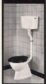
GEBERIT-PVC-Spülkasten Nr. 10.000, mit Spülrohr 2"×1<sup>1</sup>/<sub>2</sub>", Länge 70×22 cm. Nr. 44.020 für am Boden befestigtes Klosett
