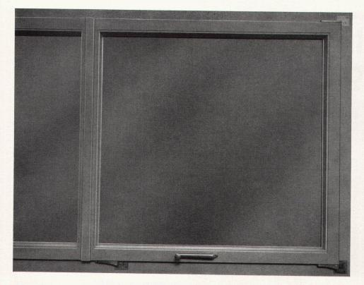
Hervorragende Bedienungs-, Lüftungs- und Wartungseigenschaften zeichnen diese Konstruktion aus. Die Dauerlüftung wird durch die regulierbare Parallelabstellung erreicht, die Direktlüftung durch das Hinterschieben des Gleitflügels. Zur Reinigung kann der Parallelabstellflügel seitlich geöffnet werden. Das Fenster ist auch als Einflügeltyp erhältlich.
