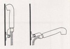
Grösste Verstellbarkeit der Strahlrichtung ohne Knickgefahr für den Schlauch
