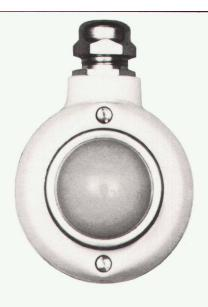
Die Zentralsteuerung von sämtlichen Lamellen-Storen an einem Gebäude ermöglicht nun auch die vollautomatische Bedienung. Die links abgebildete LUXOMAT-Sonnenzelle wird an der Fassade montiert. Dort reagiert sie feinfühlig auf die Sonnenbestrahlung und schickt Impulse an die Zentralsteuerung. Diese wiederum lässt die auf dem Schaltertableau vorgewählten Storen funktionieren. Diese sinnvolle Einrichtung ist weit mehr als nur Bequemlichkeit, sie bringt entscheidende Vorteile und Einsparungen.
