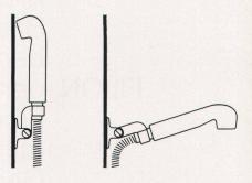
Grösste Verstellbarkeit der Strahlrichtung ohne Knickgefahr für den Schlauch
