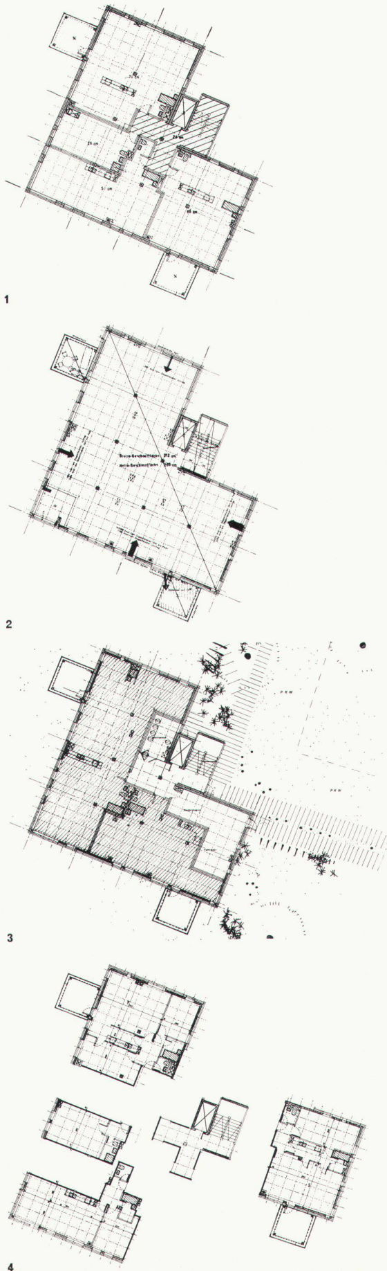
1-8 Verschiedene Veränderbarkeitsstufen eines achtgeschossigen Wohnhausprojekts für Berlin im Grundriß Plans d'un projet pour un immeuble à huit étages à Berlin: la variabilité se situe à divers niveaux de l'aménagement Plans of a structure project in Berlin comprising eight floors and allowing variations on different levels of the flexibility
