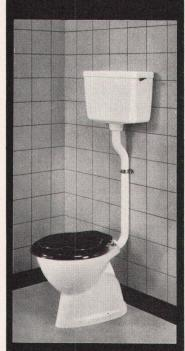
GEBERIT-PVC-Spülkasten Nr. 10.000, mit Spülrohr 2"×1<sup>1</sup>/<sub>2</sub>", Länge 70×22 cm, Nr. 44.020 für am Boden befestigtes Klosett
