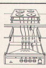
dem mitgelieferten Einbaurahmen eingeschoben; dadurch einfachste Demontage bei allfälligen Reparaturen.
